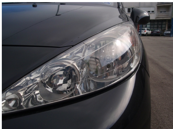
Slika 1. Primjer ispravno ugrađenog prednjeg pozicijskog svjetla, sa predviđenim mjestom ugradnje od strane proizvođača
