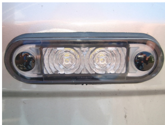
Slika 2. Primjer ispravno ugrađenog prednjeg pozicijskog svjetla, kada nema predviđenog mjesta ugradnje od strane proizvođača
