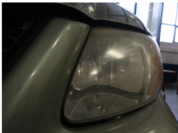
Slika 3. Primjer neispravno ugrađenog prednjeg pozicijskog svjetla(nije bilo predviđenog mjesta ugradnje, pa je stranka sama bušila rupu za žarulju)
