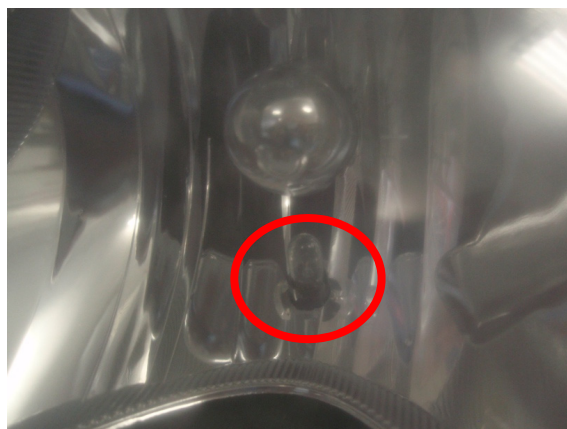
Slika 3. Primjer neispravno ugrađenog prednjeg pozicijskog svjetla(nije bilo predviđenog mjesta ugradnje, pa je stranka sama bušila rupu za žarulju)
