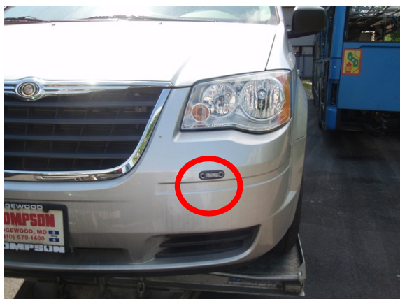
Slika 2. Primjer ispravno ugrađenog prednjeg pozicijskog svjetla, kada nema predviđenog mjesta ugradnje od strane proizvođača
