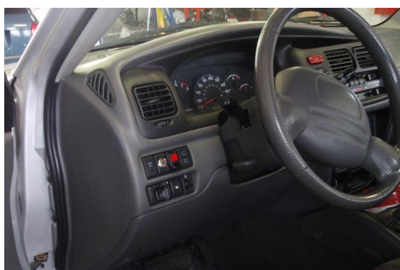
Slika 8. Primjer ugrađenog tipkala s odgovarajućim simbolom i indikatorom upaljenosti
