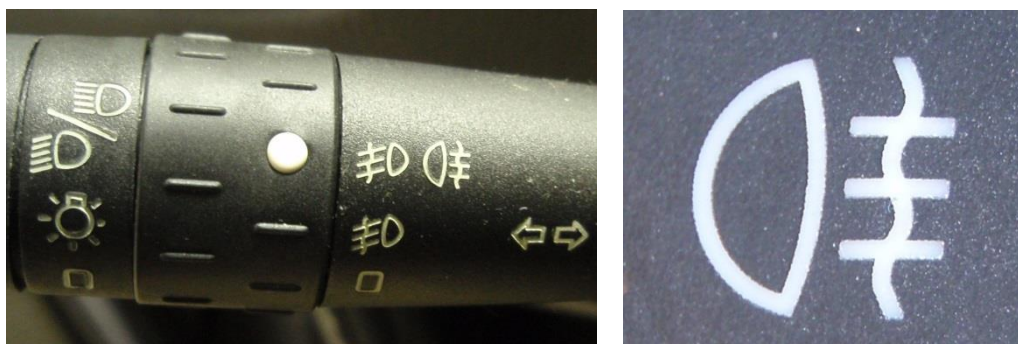
Slika 2. Primjer ispravne oznake prekidača stražnjeg svjetla za maglu
