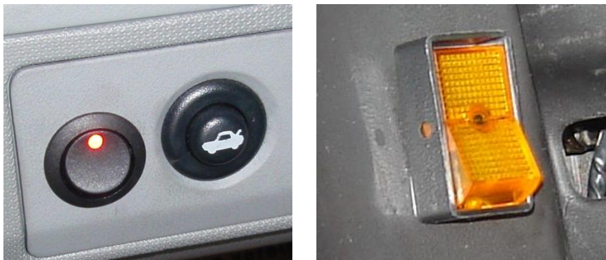
Slika 1. Primjer prekidača stražnjeg svjetla za maglu koji nije izveden u skladu s pravilnikom
