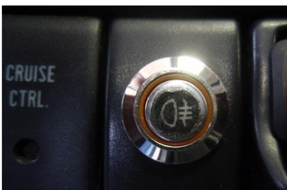
Slika 8. Primjer ugrađenog tipkala s odgovarajućim simbolom i indikatorom upaljenosti
