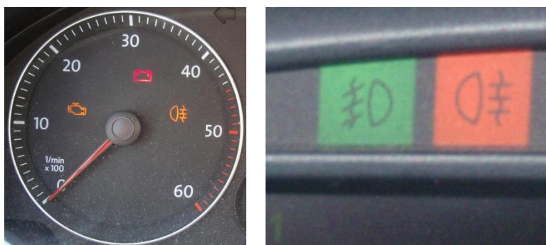
Slika 3. Kontrolno svjetlo uključenosti stražnjeg svjetla za maglu
